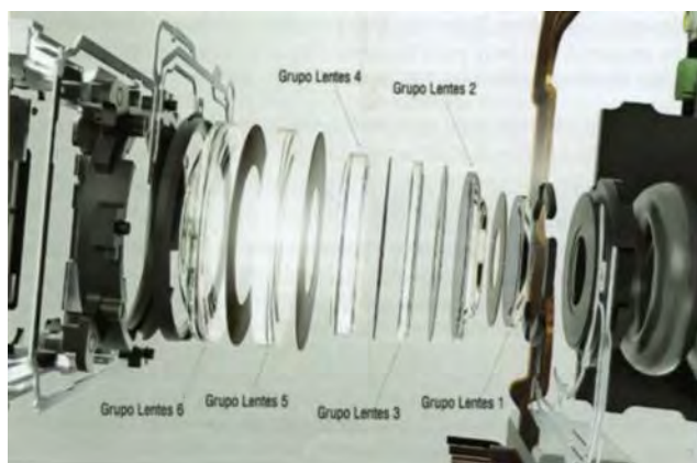
Figura 8. Exemple d'estructura de bloc òptic (objectiu) muntat en una càmera d'smartphone. (Extret de Rivas, 2015).
